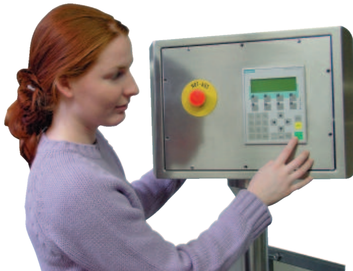
Bild 13: Schaltkasten mit der Bedieneinheit für die Programmsteuerung [Simatic OP7]
