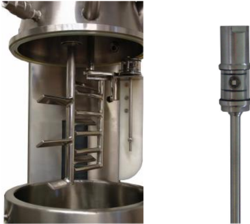
Bild 12: Temperaturmeßsystem mit Infrarotübertragung der Meßwerte
