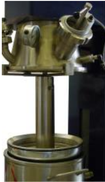
Bild 93: Planetenrührwerk HRV 15 mit eingebautem Ausdrückstempel
