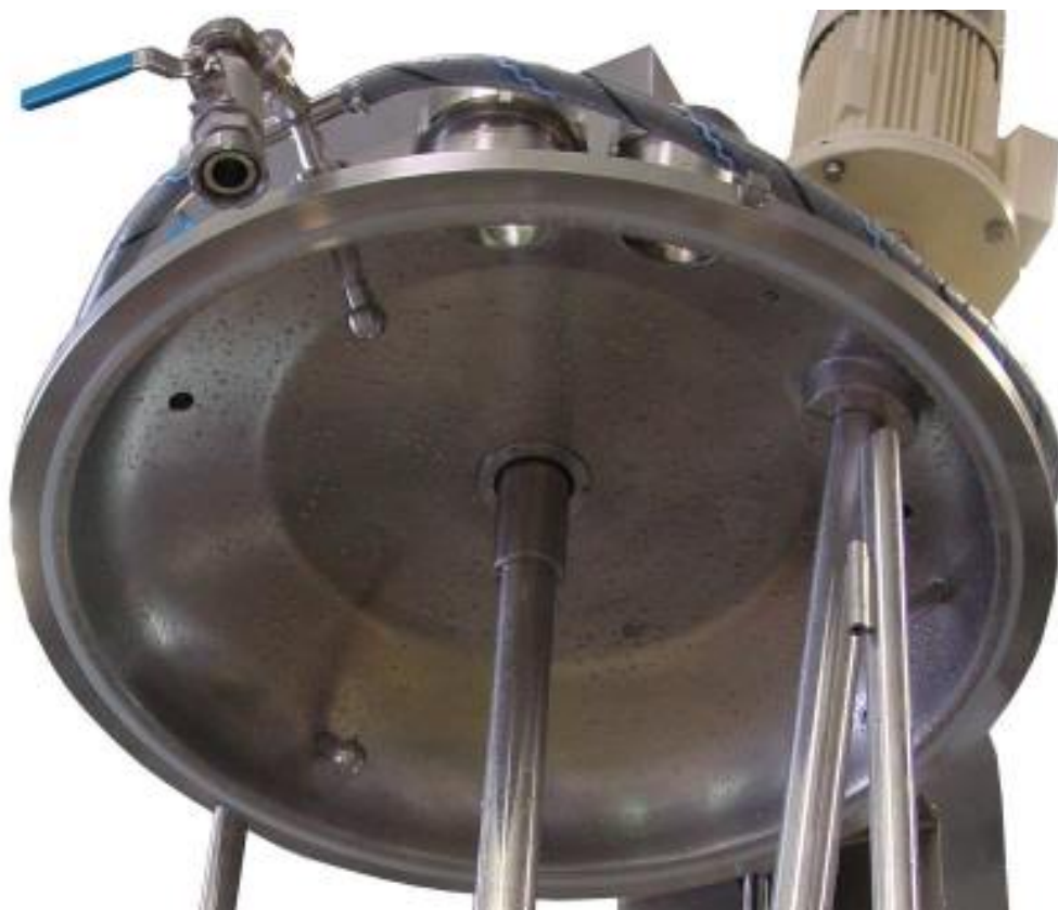
Bild 95: Sprühköpfe in der Behälterhaube eines Rührwerks
